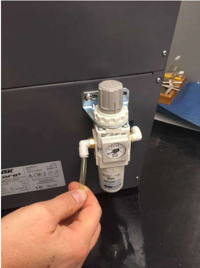
Fig.5 – Conexión de aire
