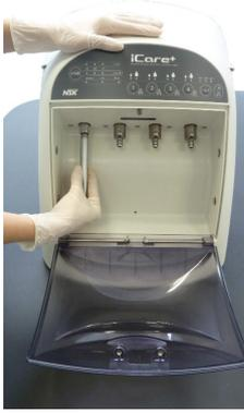
Fig.14 – Conexión de la turbina
