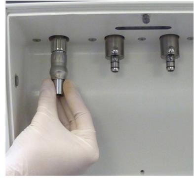
Fig.16 – Adaptador de la turbina
