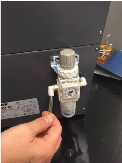
Fig.5 – Conexión de aire
